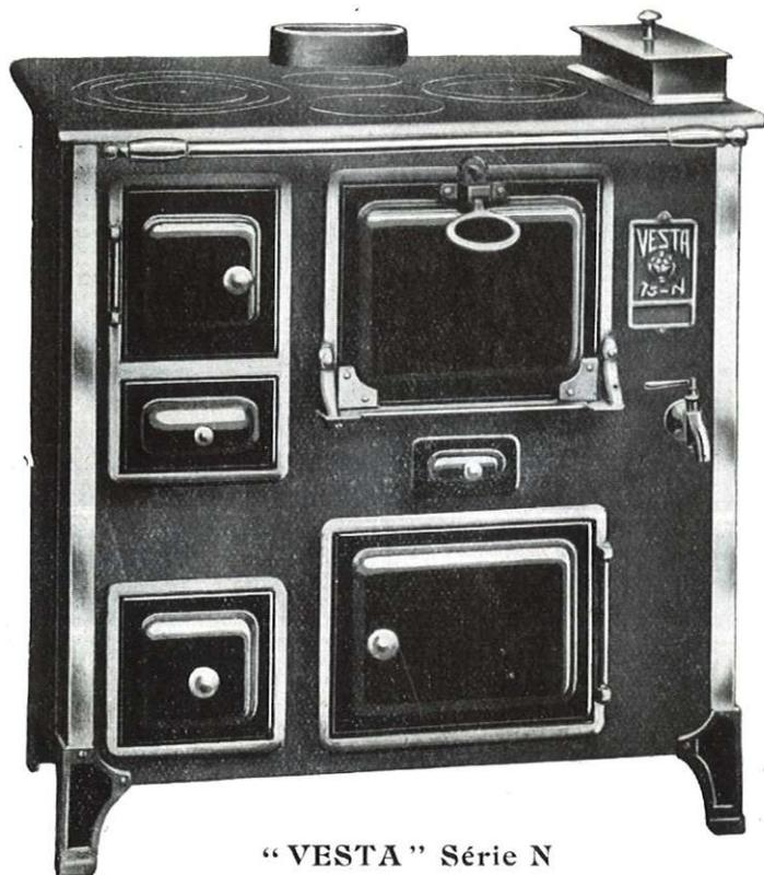
Façade et portes en tôle d'acier emboutie. Portes double paroi. — Dans les cuisinières émaillées, encadrement des portes, barre et panaches nickelés, bouillotte fonte émaillée. — Foyer en briques réfractaires à droite et à gauche avec grille abattante amovible, contrefeu renforcé. Buse mobile pouvant se monter soit sur la plaque, soit à l'arrière du fourneau.
