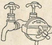
Cet appareil, en cuivre nickelé, est composé d'un boîtier en deux parties entre lesquelles se trouve une plaque filtrante que l'on peut changer à volonté.
