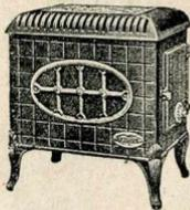
N° 700412. — Entièrement en fonte, façade, côtés, pieds, dôme en fonte émaillée. Dimensions : hauteur totale 56 %, largeur du corps 48 %, profondeur du corps 33 %, diamètre extérieur de la buse 0,683. Il utilise des bûches de 42 %. Capacité de chauffe 100 m<sup>3</sup>. Prix : 295 \*
