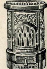
N° 700498. — Fonte émail céramique, corps du foyer coulé d'une seule pièce sans joint. Hauteur 75 %, largeur 51 %. Capacité de chauffe 90 à 120 m<sup>3</sup>. Prix : 435 \*
