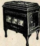
Modèle tout fonte, avec sole en briques réfractaires, muni de pare-feux de protection. Le dôme est à charnière et découvre un tampon mobile.
