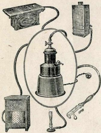
L'appareil " AÉROGAZ " comble une lacune partout où, disposant du courant électrique, le gaz de ville fait défaut. Il ne nécessite aucun frais d'installation et, suivant le modèle, permet d'alimenter un réchaud à gaz à un, deux feux et four, un chauffe-bain, des fers à souder, un four à émailler, l' " AÉROGAZ ", de construction mécanique soignée et sans organes délicats, est d'un fonctionnement irréprochable.
