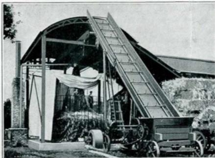
Fig. 6. — Aspect d'ensemble d'une installation de fenaison artificielle. Au premier plan : l'élevateur électrique à foin. Au second plan : à gauche, le générateur d'air chaud chauffé au coke; à droite, la meule en cours d'érection.
