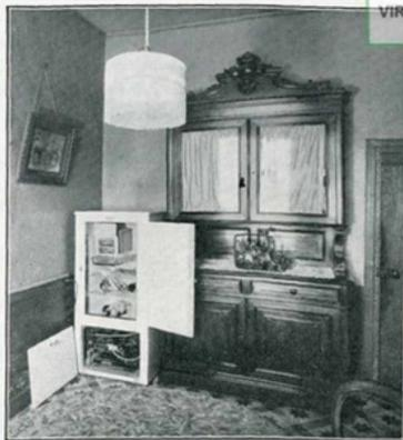
Fig. 4. — Appareil domestique installé dans la salle à manger de la ferme de Beauval. Le panneau inférieur a été enlevé pour laisser voir la machinerie.
