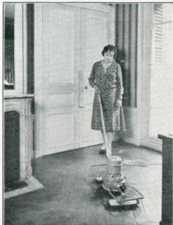
Fig. 1. — Cirreuse à une brosse circulaire et deux brosses à mouvement alternatif.
