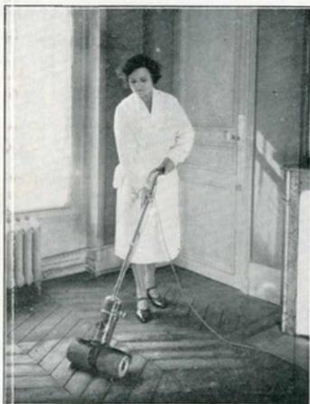
Fig. 2. — Cirreuse à brosses cylindriques, équipée pour le décapage d'un parquet.
