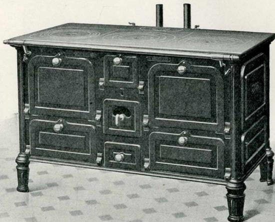
Ces cuisinières, entièrement en fonte, ont un foyer rectangulaire au milieu. Deux registres placés l'un à droite, l'autre à gauche du meuble, permettent de chauffer les fours ensemble ou séparément.
