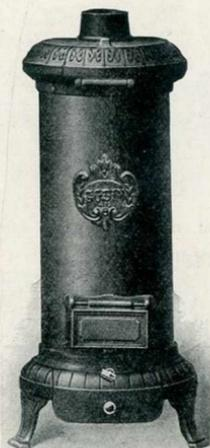
Ces calorifères possèdent à la partie inférieure une porte coulissante qui sert au réglage de l'entrée de l'air. On fait tomber les cendres au moyen de la targe placée sur le socle. Ils possèdent un tiroir en tôle.
