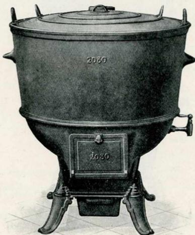
Ces buanderies possèdent un foyer construit pour brûler la houille, il est garni de terre réfractaire pour permettre l'utilisation complète du combustible. Elles possèdent en outre, à la partie inférieure, un firoir en fonte avec poignée, elles sont toujours à buse dessus. Les buanderies N<sup>os</sup> 2023 à 2034, ont toujours le robinet placé à droite.
