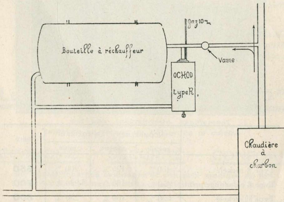
Schéma d'intercalation d'Appareil "OCHOD" type R ou RD
