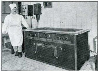
Fig. 6. — Cuisinière pour très grosse installation domestique comprenant un four, deux feux vifs, une plaque chauffante de grand diamètre et deux de petit diamètre.
