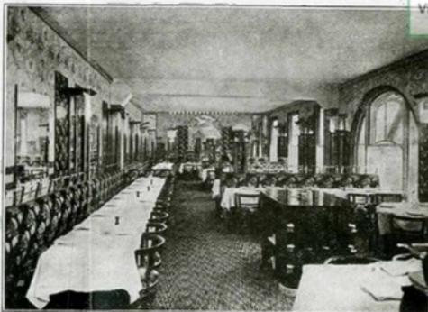
Fig. 4. — Le Restaurant Josset. — La salle de restaurant au premier étage. L'éclairage est assuré au moyen de réflecteurs placés sur colonnes dans l'axe central de la salle (indirect) et par des boules en verre pressé latérales (semi-direct).
