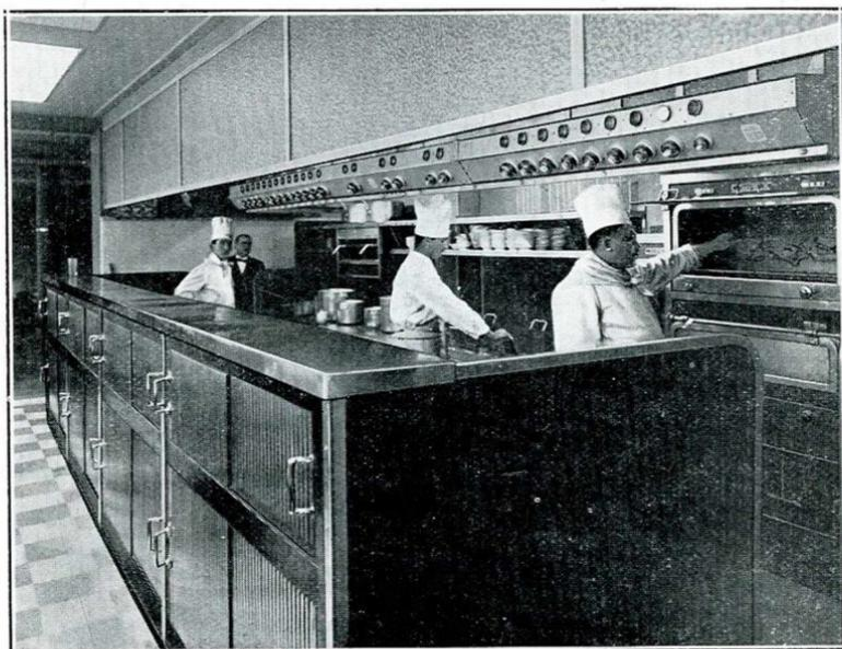
Fig. 17. — Table chaude et armoire chauffante à portes coulissantes.
