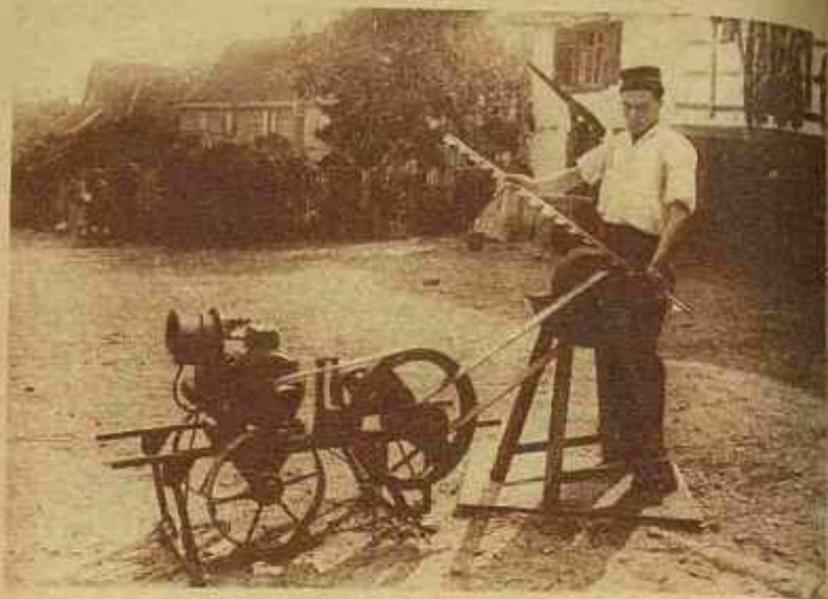
*La manivelle actionnée électriquement facilite la précision de l'affilaison.*
