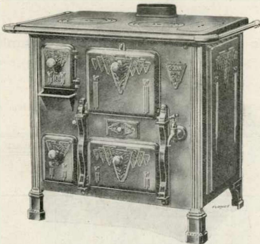
Les nouveaux fourneaux 100 à 104 et 100<sup>D</sup> à 104<sup>D</sup> ont la devanture en fonte. Les portes, également en fonte, sont bombées et ornées style moderne. Le four est chauffé par la circulation de la flamme. Le foyer, toujours en fonte, est mixte et rétrécissable. La buse peut être placée à volonté dessus, derrière en haut, ou à mi-hauteur du fourneau.
