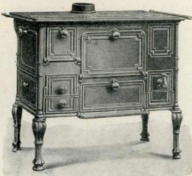
Les cuisinières N°s 1240, 1241, 1242 et 1243 ont un foyer à houille rectangulaire et rétrécissable. Le four est chauffé par la circulation des flammes. La buse est mobile et peut être placée dessus ou derrière.
