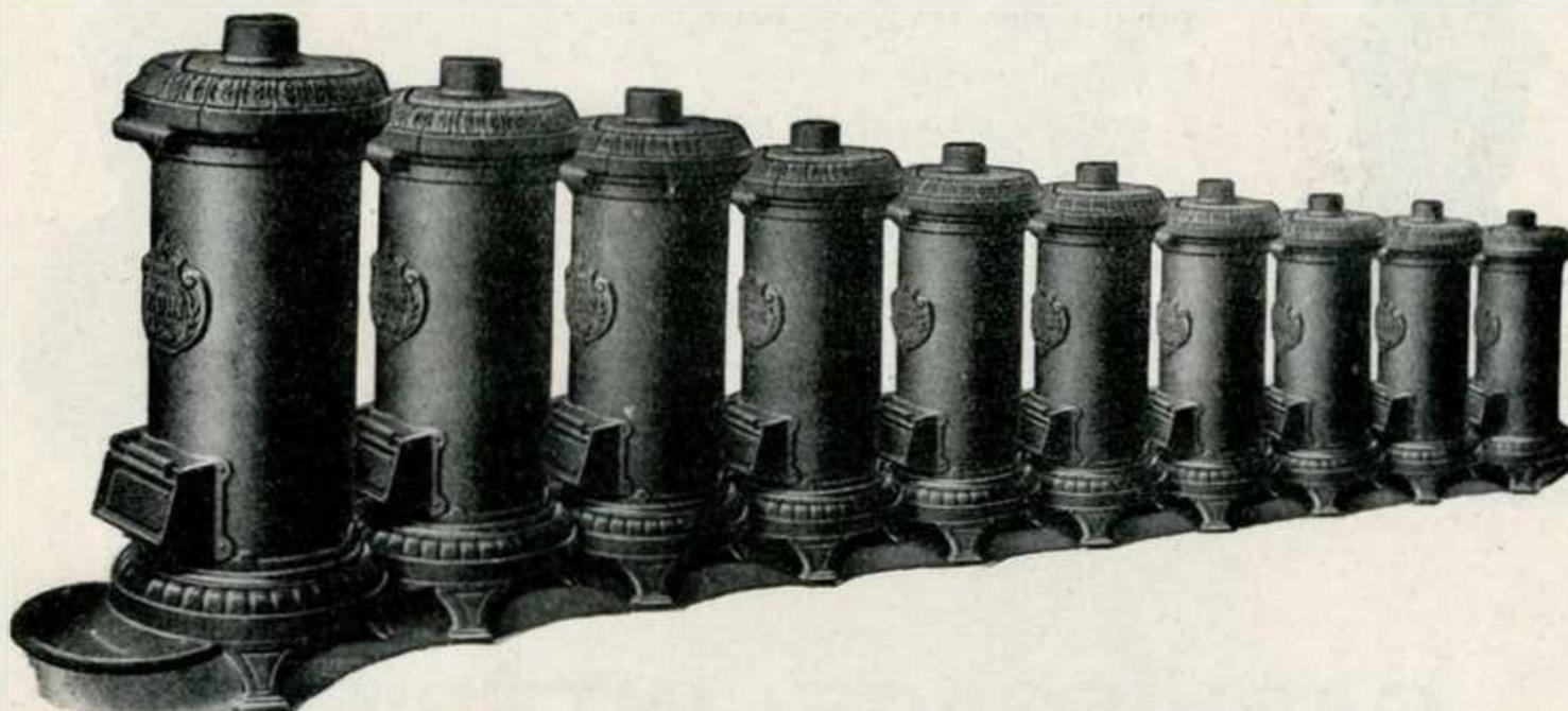
Les calorifères hygiéniques N<sup>os</sup> 2000, 2001, 2001 *bis*, 2002, 2002 *bis*, 2003, 2004, 5, 5 *bis* et 5<sup>c</sup> n'ont ni grille ni tiroir à cendres ; la combustion s'opère sur une sole en terre réfractaire. Le fût est en tôle ; il est garni intérieurement sur toute sa hauteur de briques réfractaires. La porte d'admission d'air sur la sole est coulissante.
