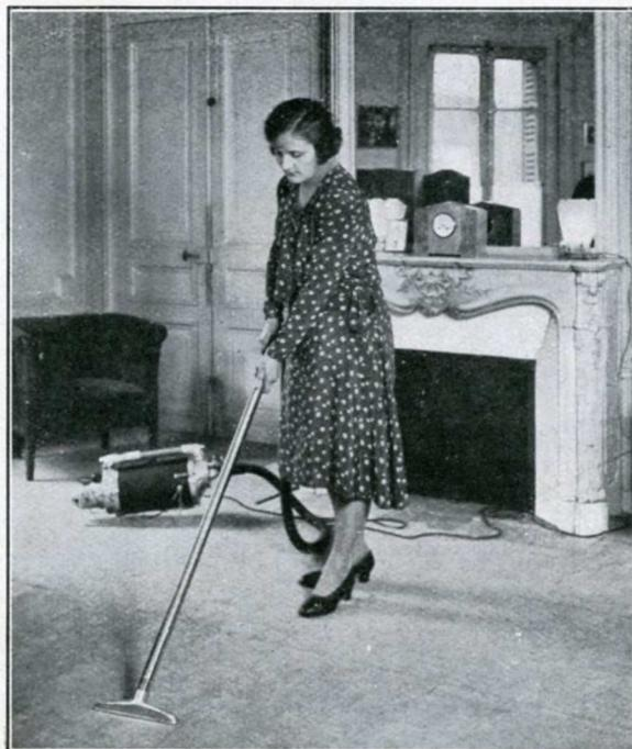
Fig. 8. — Aspirateur à réservoir fixé sur traîneau (montage b).
