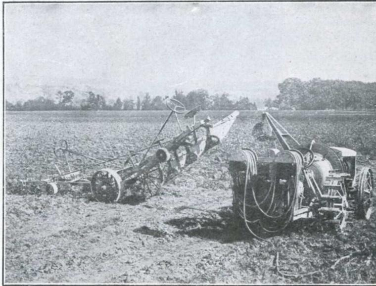
Fig. 1. — Chantier de labourage électrique.
