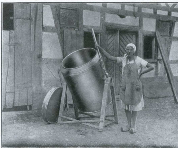
Fig. 2. — Chaudron de 400 litres, puissance 5 kW.
