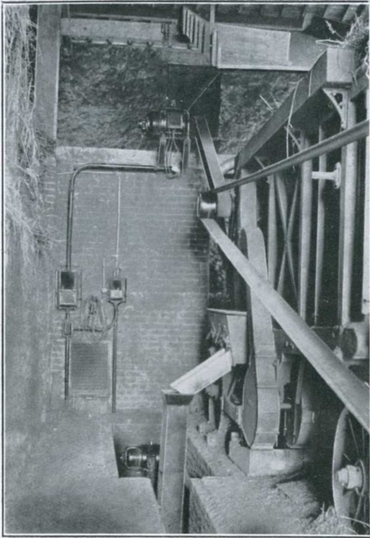
Fig. 1. — Disposition des moteurs actionnant la batteuse et la soufflerie pour l'emmagasinage du grain dans les greniers.
