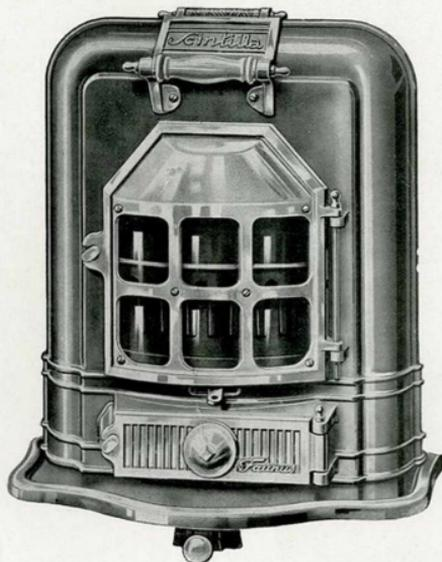
Entièrement en fonte, le foyer est garni de briques réfractaires. Les portes de façade, de chargement et de cendrier sont à joint d'amiante. Le corps, à carreaux de fumée latéraux, parfaitement étanche, assure une obturation complète de l'air. La valve à vis placée sur la porte du cendrier permet de doser l'entrée d'air et de régler l'allure de la combustion. Le dégrasage par grille à pivot est commandé extérieurement par une trottette.
