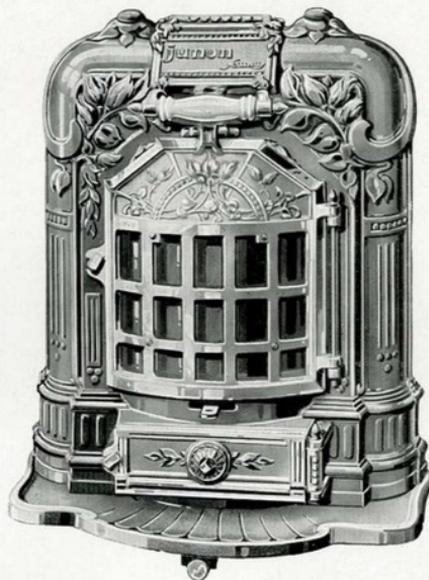
Entièrement en fonte, le foyer est garni de briques réfractaires. Les portes de façade, de chargement et de cendrier sont à joint d'amiante. Le corps, à carnaux de fumée latéraux, parfaitement étanche, assure une obturation complète de l'air. La valve à vis placée sur la porte de cendrier permet de doser l'entrée d'air et de régler l'allure de la combustion. Le décrassage, par grille à pivot, est commandé extérieurement par une tirette.
