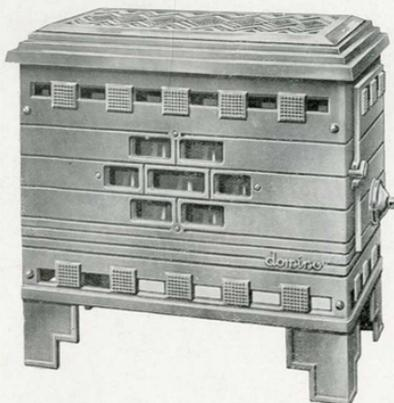
Facade et côtés fonte émaillée. Dessus de dôme mobile **nicketé mat**. Coffre en forte tôle d'acier soudé électriquement. Sole en briques réfractaires, porte à joint hermétique, réglage par valve à vis, micas pouvant être changés facilement.
