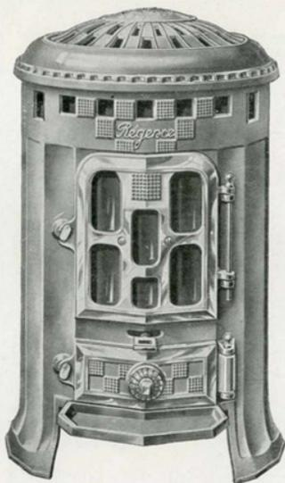
Façade et dôme en fonte émaillée **ajourée**, dessus de dôme **nickelé** à charnière. Corps en fonte parfaitement étanche, garni de briques réfractaires dans la partie du foyer. Joint d'amiante aux portes de chargement de façade et de cendrier. Réglage unique par valve à vis placée sur la porte du cendrier. Décrassage par grillo à pivot commandée extérieurement par une tirette.
