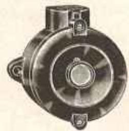
Poussoirs bakélite étanches pour sonneries ou minuterias. Entrée pour tube acier de 11<sup>m</sup>/<sub>m</sub>. 6 ampères, 250 volts.
