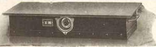
**Plaques chauffantes pour réfectoires, menuiseries, plaquage, etc.** Types : 17191 à 17194. Consommation depuis 250 watts suivant chaleur exigée. Se font en toutes dimensions et pour tous ampérages. Prix sur demande. Tôle d'acier 3 allures de chauffe. On obtient 100° environ en 20 minutes. On peut ensuite ralentir l'allure.
