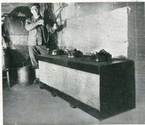
Fig. 1 Four triple de 12 kW pour le recuit des coins.
