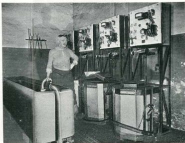
Fig. 2. — Fours de 6 kW pour la trempe et le recuit des coins monétaires. A gauche, le bain à trempe.
