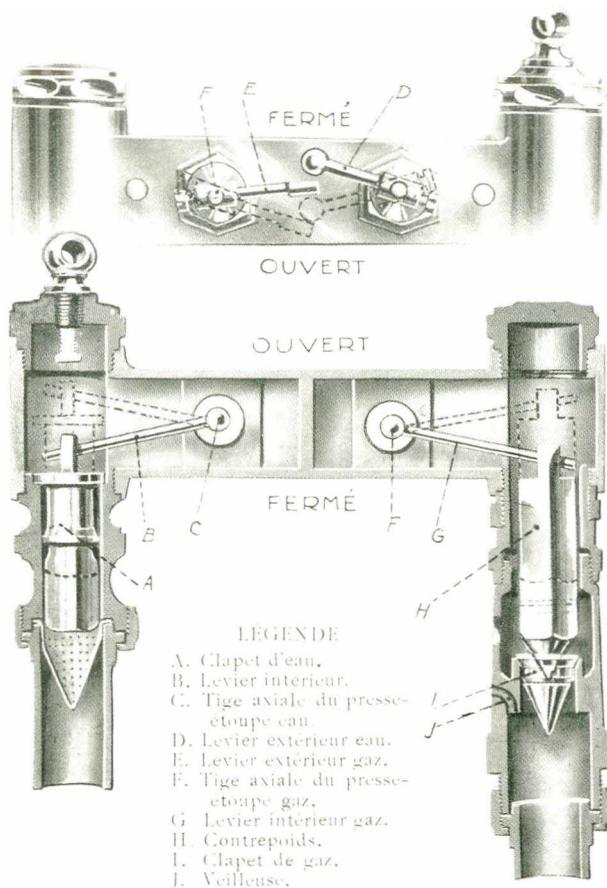
**FONCTIONNEMENT.** — A l'ouverture d'un robinet "Chaud", l'eau soulève le clapet A pour pénétrer dans le serpentin. Ce mouvement est transmis par le levier B à la tige axiale C. Celle-ci, par un **très léger mouvement de rotation** (30°) qui ne fatigue pas le joint, transmet ce mouvement au levier D.
