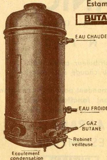
Ce chauffe-eau étant à écoulement libre le raccorder sur un robinet dont on ait retiré le clapet intérieur, ou bien sur un tuyau se déversant directement sur l'appareil à alimenter : bidet, lavabo, etc. Se commande par les robinets d'arrêt.
