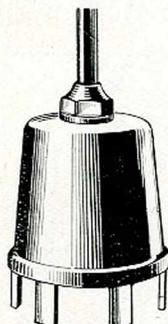
La cloche à plongeur est descendue au fond de la cavité à contrôler : Un équilibre s'établit entre le poids de la colonne de liquide au-dessus de la cloche et l'air emprisonné dans la conduite. La pression d'équilibre est enregistrée par l'organe déformable et donne instantanément la hauteur de la colonne liquide.
