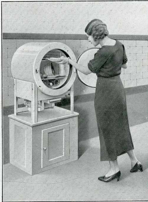
Fig. 4. — Une armoire à froid à très grand détendeur.
