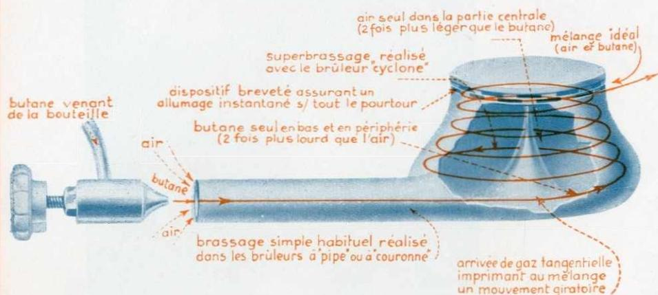
un **brassage violent** des molécules si dissemblables d'air et de butane, qui les oblige à se mélanger de façon intime et parfaite, grâce à un mouvement giratoire ascensionnel très rapide formant véritable cyclone
