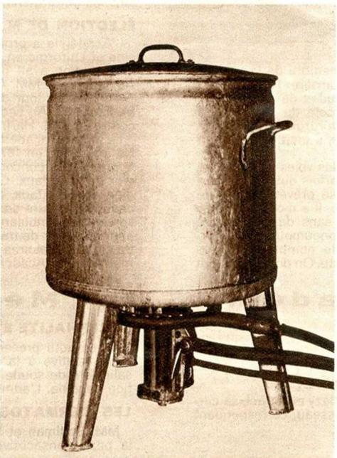
Fig. 18. — MACHINE A LAVER LE LINGE A PISTON
