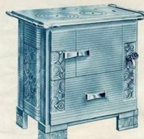
CUISINIÈRE CALORIA "COMMODORE" N° 611 Cuisinière moderne en fonte émaillée. À retour de flammes. Foyer mûle et porte à chaudière. Chaudière effluvente. Robinet à pression. Grand tiroir reculant à usage d'étove ou de charbonnière. Largesurs : 83 cm. Dépous : 596 fr.
