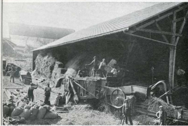
Fig. 2. — Vue de l'Entreprise Muller. Scène prise à l'Amour de Dieu, près de Troissy (Marne). Batteuse de 150 quintaux par jour, élévateur de gerbes, presse à haute densité, moteur de 25 ch.
