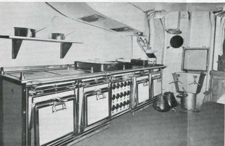
Fig. 11. à gauche. — Les cuisines de la malle « Prince Baudouin ». Fourneau à 7 plaques, 4 fours et un grill. Puissance : 45 kW.
