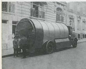
Fig. 2. — Benne à tambour tournant. Ville de Paris.
