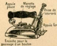
FIG. 106. — Fer à régulateur de température et avec encoche permettant de passer sous les boutons.
