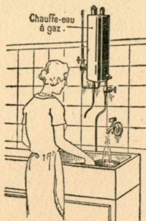
FIG. 6. — Chauffe-eau à gaz au-dessus d'un évier.
