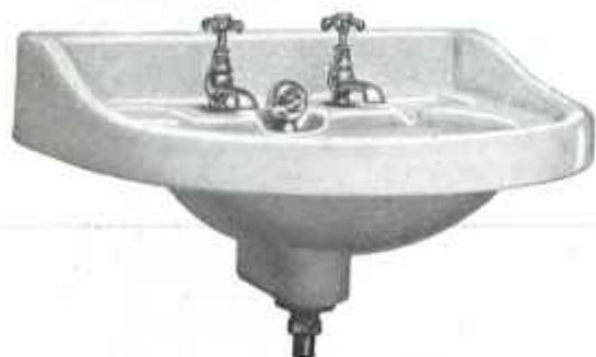
N° 615. — Lavabo porcelaine Dimensions 63 × 46 ou 70 × 50 2 Robinets, vidage à bonde ou à clapet 2 Consoles fonte, 1 Ceinture fer plat
