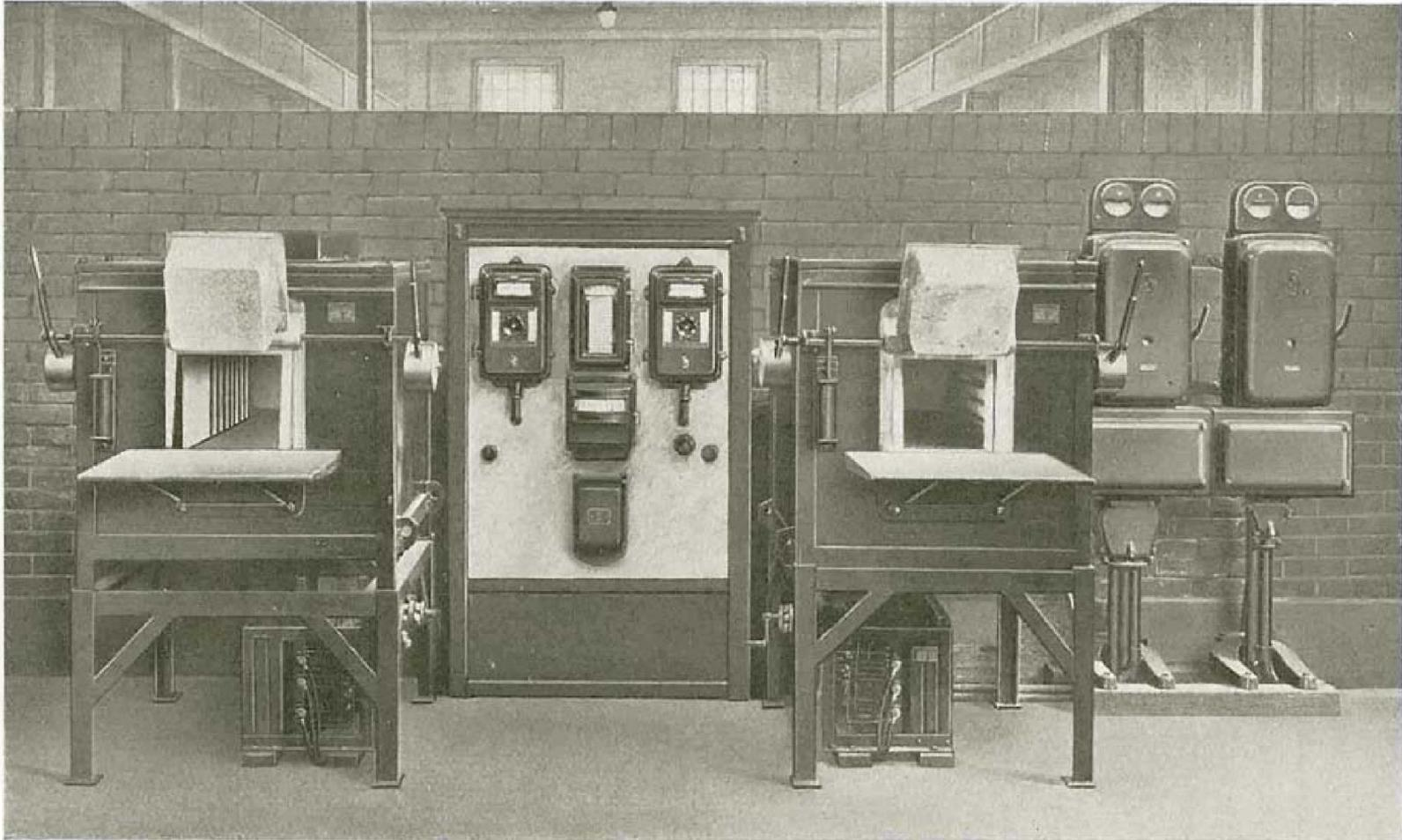
Temperaturregler an einem Elektromuffelofen. Der Regler steuert über ein Zwischenrelais ein Schütz, durch das der elektrische Strom für die Heizwicklung ein- oder ausgeschaltet wird. Die Temperaturkurve wird durch einen Einkurvenschreiber aufgezeichnet. Auf der Tafel zwei wasserdichte Umschalter zum Umschalten der eingebauten Anzeigeinstrumente auf verschiedene Meßstellen.
