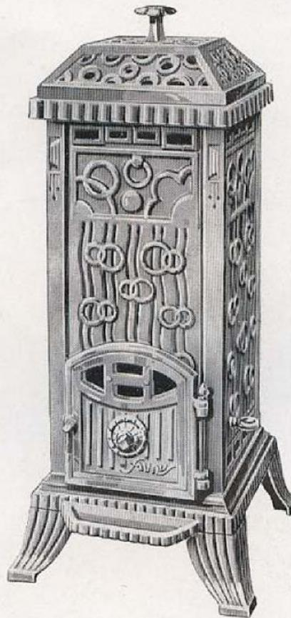
Panneaux, dôme à charnières et pieds fonte émaillée ; enveloppe intérieure protégée par un revêtement en briques réfractaires. Porte à joint d'amiante. La valve à vis placée sur la porte permet de doser l'entrée d'air et de régler l'allure de la combustion. Le dégrassage, par grille à pivot, est commandé extérieurement par une tirette.
