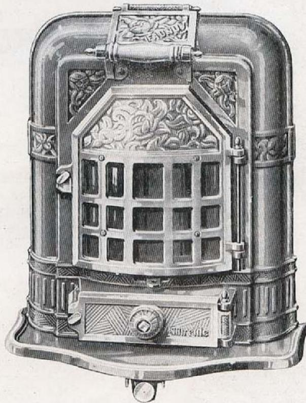
Entièrement en fonte, le foyer est garni de briques réfractaires. Les portes de façade, de chargement et de cendrier sont à joint d'amiante. Le corps, à carreaux de fumée latéraux, parfaitement étanche, assure une obturation complète de l'air. La valve à vis placée sur la porte du cendrier permet de doser l'entrée d'air et de régler l'allure de la combustion. Le décrassage par grille à pivot est commandé extérieurement par une tirette.
