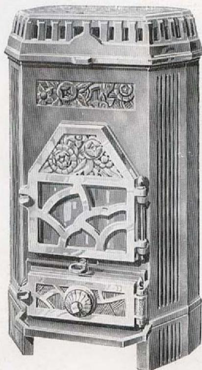
Façade et dôme en fonte émaillée. Corps en fonte parfaitement étanche protégé dans la partie du foyer par un revêtement en briques réfractaires. Les portes de chargement, de façade et de cendrier sont à joint d'amiante. La valve à vis placée sur la porte du cendrier permet de doser l'entrée d'air et de régler l'allure de la combustion. Le dégrassage par grille à pivot est commandé extérieurement par une tirette.
