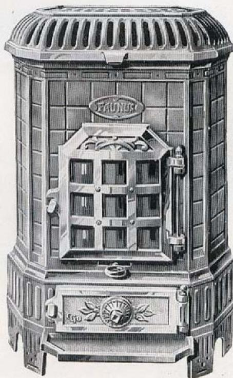
Façade et dôme en fonte émaillée. Corps en fonte parfaitement étanche protégé dans la partie du foyer par un revêtement en briques réfractaires. Les portes du chargement, de façade et de cendrier sont à joint d'amiante. La valve à vis placée sur la porte du cendrier permet de doser l'entrée d'air et régler l'allure de la combustion. Le décrassage, par grille à pivot, est commandé extérieurement par une tirette.
