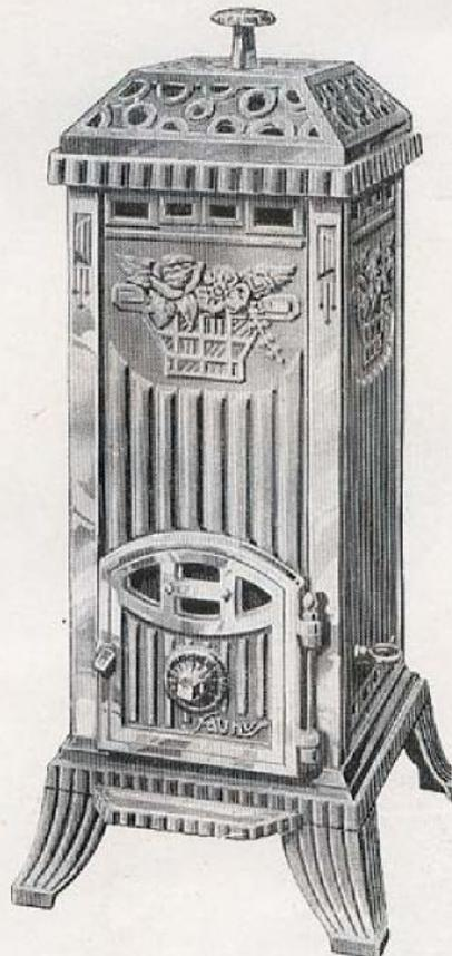
Panneaux, dôme à charnières et pieds fonte émaillée : enveloppe intérieure protégée par un revêtement en briques réfractaires. Porte à joint d'amiante. La valve à vis, placée sur la porte, permet de doser l'entrée d'air et de régler l'allure de la combustion. Le décrassage, par grille à pivot, est commandée extérieurement par une tirette.
