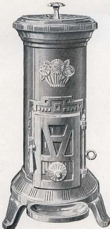
Dôme à charnières. - Corps tôle glacée garni briques réfractaires. - Portes de chargement et de façade à joint d'amiante. - Réglage par valve à vis placée sur la porte de façade. - Décendrage par grille pivotante commandée extérieurement par une tirette. - Grand tampon de chargement à charnières permettant le chauffage au bois.
