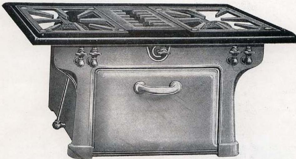
Porte de four **équilibrée**. Table chauffante munie de grilles reversibles. Rampe d'alimentation non apparente. Robinetterie cuivre. Cinq feux indépendants et réglables : A droite, brûleur double, à gauche, brûleur simple, au centre : brûleur réversible. Sous le four, rampe à pâtisserie. Plafond rayonnant à pointes en fonte spéciale. Lèche-frite en tôle emboutie et étamée.
