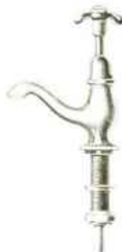
N° 756 Robinet à vis et à cache-chapeau, bec relevé de 0 m. 09.
