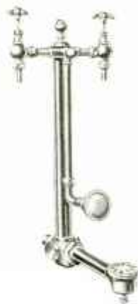
N° 627 Robinetterie complète, alimentant la baignoire par le bas, vidage américain avec trop-plein combiné. Se monte avec boîte à 4 raccords.
