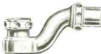
N° 635 Siphon spécial pour baignoire, permettant le départ de la vidange dans toutes les directions. Se monte sur toutes nos robinetteries et vidages de baignoires.
