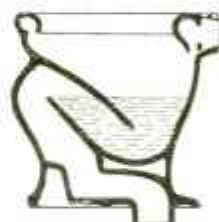
Coupe de la cuvette siphonique.
