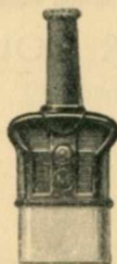
733. - Fiche bipolaire en bakélite avec embase en porcelaine résistant aux plus hautes températures, 10 amp. - 250 v. Modèle déposé. 4. »
