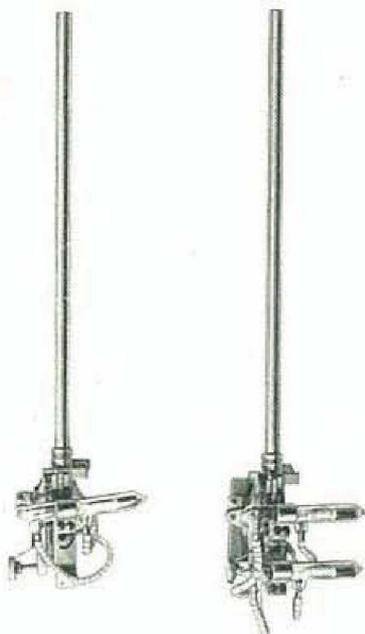
L'interrupteur est un basculeur à mercure par pôle.
