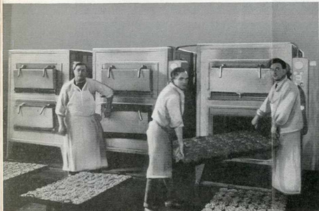
Fig. 1. — La batterie de trois fours. Enfournement des pâtés.
