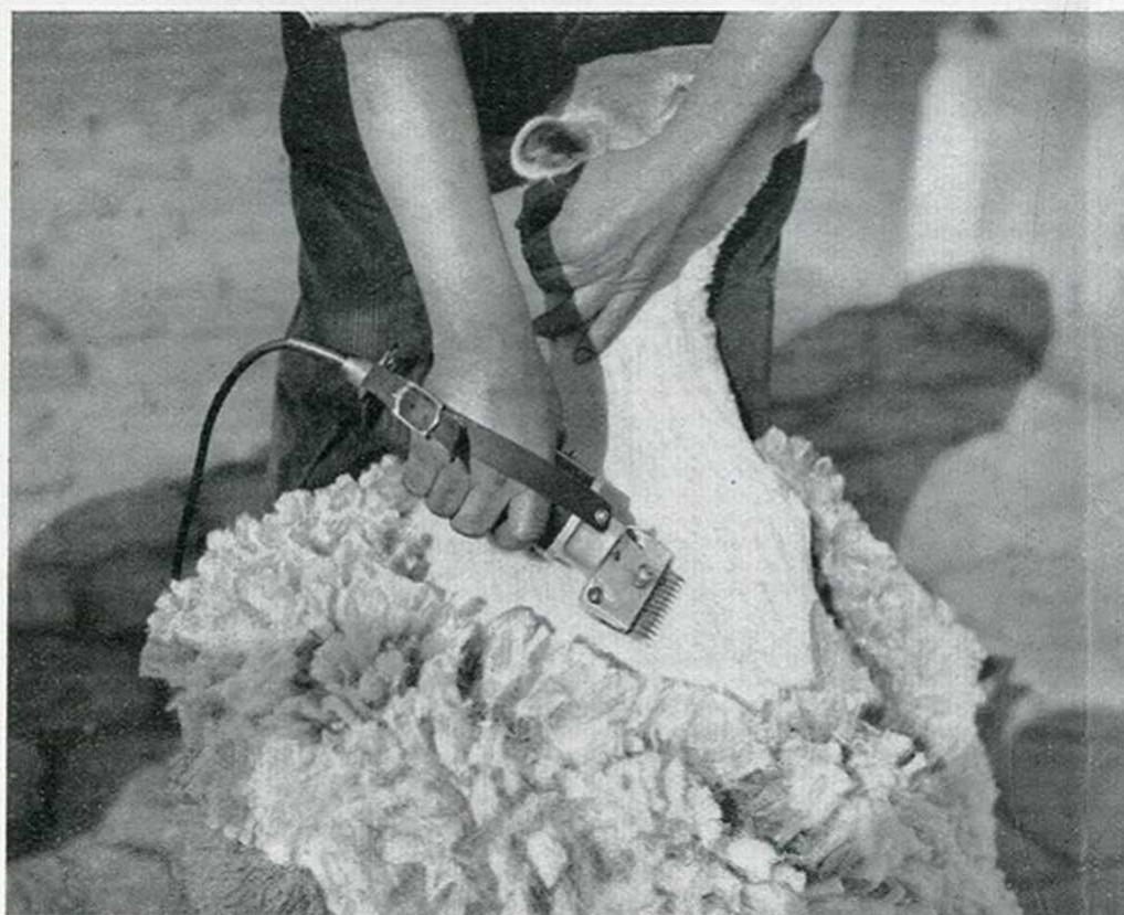
Fig. 1. — Tondeuse à commande directe (moteur électrique logé dans le manche). La laine est enlevée dans toute la longueur du poil.
