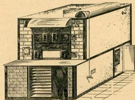
Four continu à coke ou mazout en réfractaires calorifugés
