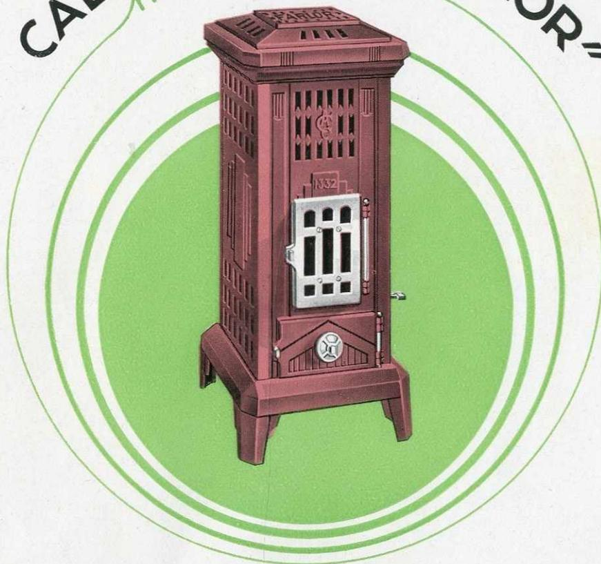
**Dispositions générales** } Grand foyer cylindrique à revêtement réfractaire pour l'usage du bois et tous charbons y compris l'anthracite et le coke; décendrage du foyer par grilles pivotantes et va et vient actionnées par une clef extérieure, réglage de combustion par bouton régulateur logé dans la façade de cendrier, feu visible, buse derrière en haut.
