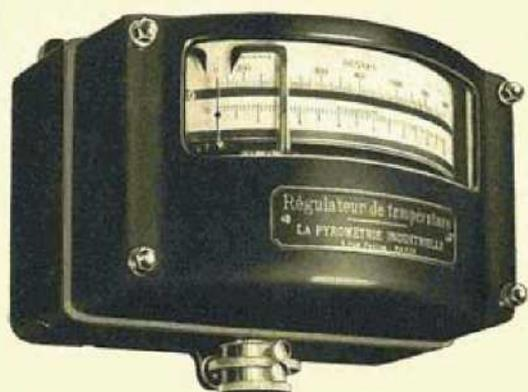
Fig. 5. - Régulateur **RU** à deux mécanismes.
