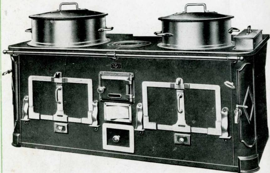
Foyer mixte bois et houille. Fours très hauts avec étagère mobile, deux vanes de réglage placées sur la façade, permettant de diriger la flamme sur l'un des deux fours. Garnitures acier forgé poli, main-courante cuivre sur la façade.
