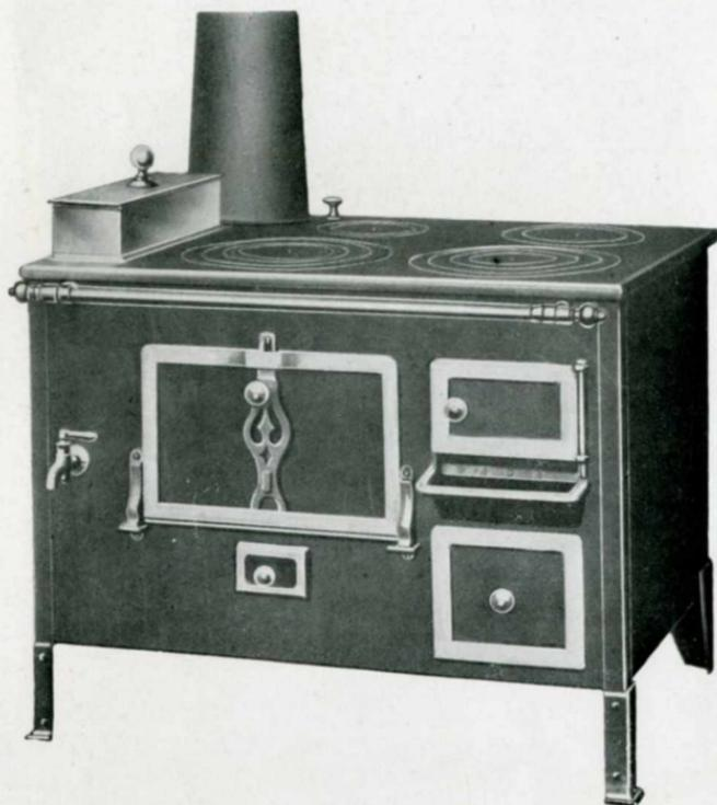
Façade en tôle. Angles fer cornière. Foyer mixte bois et charbon. Manivelle pour retour de flamme. Garnitures fonte polie demi-nickelée; fonte nickelée, cuivre ou maillechort. Chaudière en cuivre rouge étamé avec collerette et couvercle en laiton ou cuivre rouge poli, avec robinet Main-courante cuivre ou maillechort poli.
