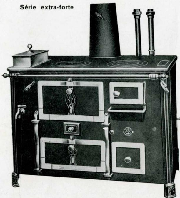
Façade tôle planée. Foyer caché ou mixte. Bouilleur en tôle d'acier soudée à l'autogène, avec tubes fer filetés. Bouchon de vidange. Etagère mobile dans le four à rôtir. Main-courante cuivre sur la façade. Clés de réglage permettant de diriger la flamme sur le four ou sur le bouilleur.
