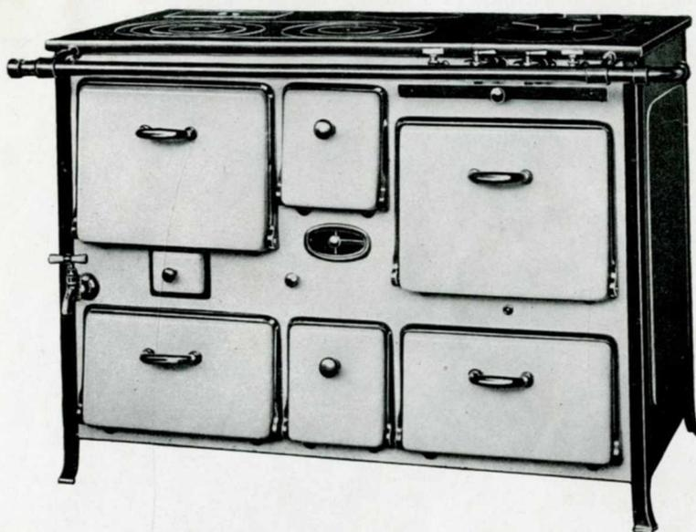
FOYER MIXTE charbon et bois, four chauffé au gaz ou au charbon pour le modèle 110. Deux fours dont l'un au charbon et l'autre au gaz pour le modèle 120. Dessus poli à ovale mobile à deux trous. Buse sur le côté. Chaudière fonte émaillée avec robinet à pression à volant bakélite. Main-courante. Boutons nickel.
