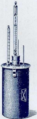
1010 Crioscope du D r STUBER pour détermination du mouillage du lait.
