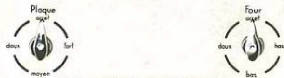
Fig. 7. — Positions des commutateurs pour plaque de cuisson, pour four-gril.
