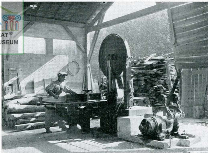
Fig. 8. - Scierie rurale. Scie à ruban actionnée par moteur individuel.
