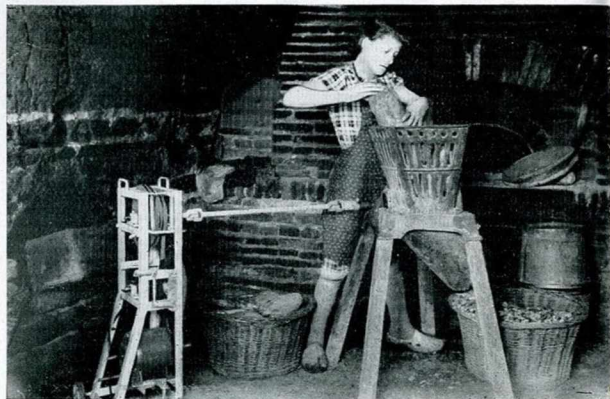
Fig. 2. - Démultiplicateur actionnant un coupe-racines par l'intermédiaire d'une transmission à cardan.
