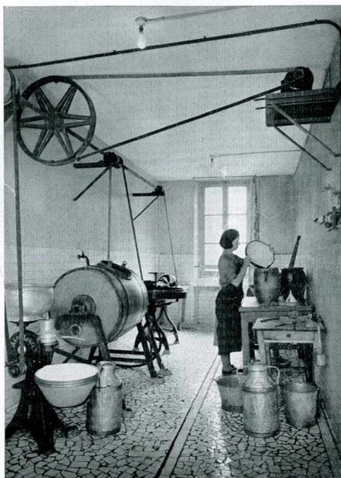
Fig. 2. - Autre disposition des transmissions. Le moteur actionne une écremeuse, une baratte et un malaxeur.
