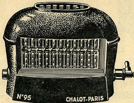
Radiateur de présentation plus simple. Le gaz porte à l'incandescence des éléments en porcelaine d'amiante donnant une forte température. Ne peut être utilisé qu'avec dégagement dans une cheminée.
