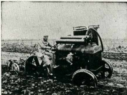
Gazogène BACO-BOIS sur Fordson.
