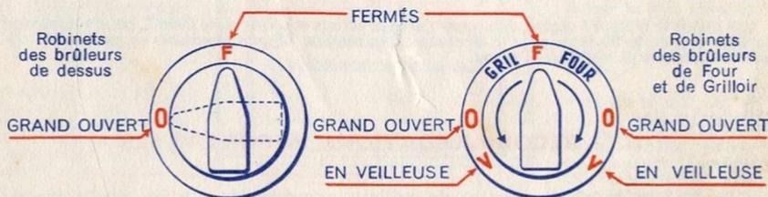
Pour manœuvrer les robinets des brûleurs de dessus, tourner les manettes vers la gauche pour ouvrir et vers la droite pour fermer. La mise en veilleuse est obtenue vers la position de fermeture.
