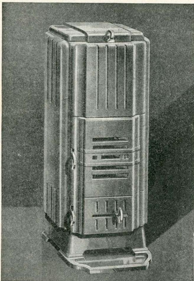
Ces calorifères type « Américain » à haut rendement ont été spécialement conçus et réalisés pour permettre l'utilisation des combustibles de petites dimensions et spécialement de la braisette et du grain d'antracite - Leur étanchéité absolue permet d'en assurer le réglage par la seule manœuvre de la coulisse d'admission d'air.
