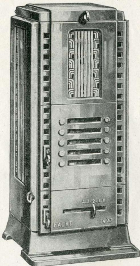
Calorifères à feu continu pouvant fonctionner plus de 24 heures sans rechargement - Corps intérieur garni de réfractaires - Boîte à fumée formant récupérateur - Réglage extrêmement simple - Grille de décendrage oscillante - SPÉCIFICATIONS STANDARD : Corps émail céramique
