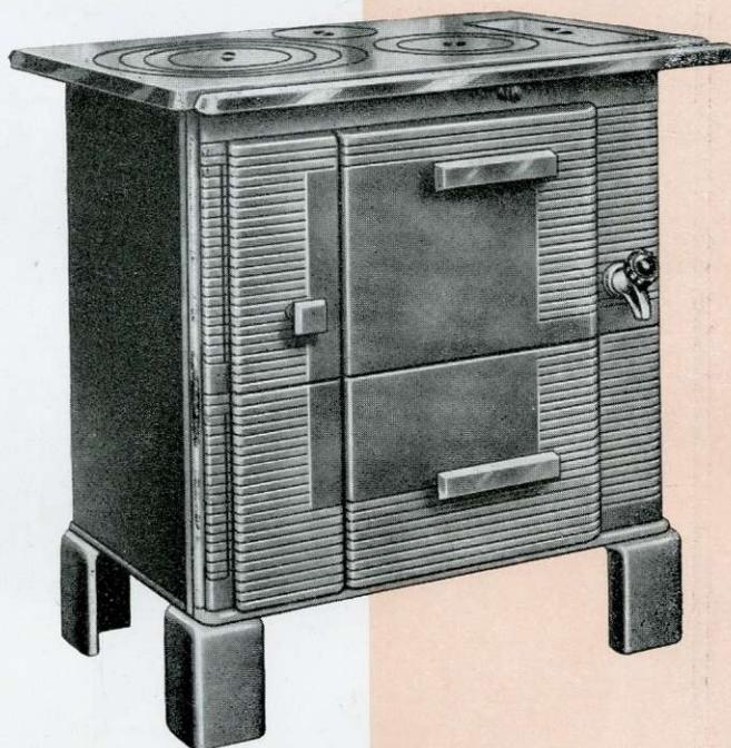
Cuisinière à retour de flammes corps acier, façade et côtés fonte émaillée. Dessus meulé. Buse ronde au milieu, dessus ou derrière. Foyer mixte ou, sur demande, foyer à houille. Chaudière affleurante. Barre devant fonte émaillée. Portes ouvrantes.
