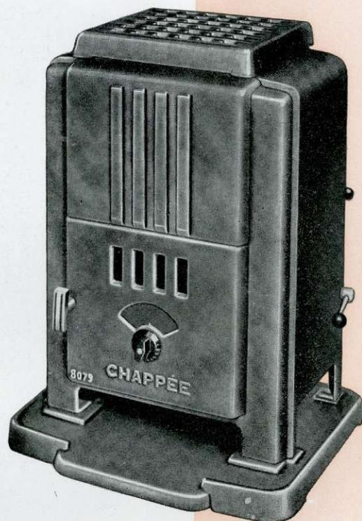
Cheminée à feu visible, en fonte émaillée, permettant l'utilisation de tous combustibles : charbons anthraciteux ou coke, calibre 20 x 30. Cet appareil à combustion à travers la masse et à départ direct a été spécialement étudié en vue d'obtenir le maximum d'économie de combustible. Haut rendement, facilité de décendrage et de nettoyage. Plateau de parquet sur demande.
